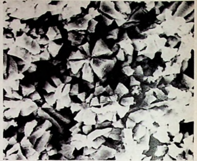
Bij een vergroting van 50 000 maal, onder de elektronenmicroscopie, vertoont het tinoxyde-oppervlak regelmatige structuren, die aan een dichtbegroeid bloembed doen denken.
